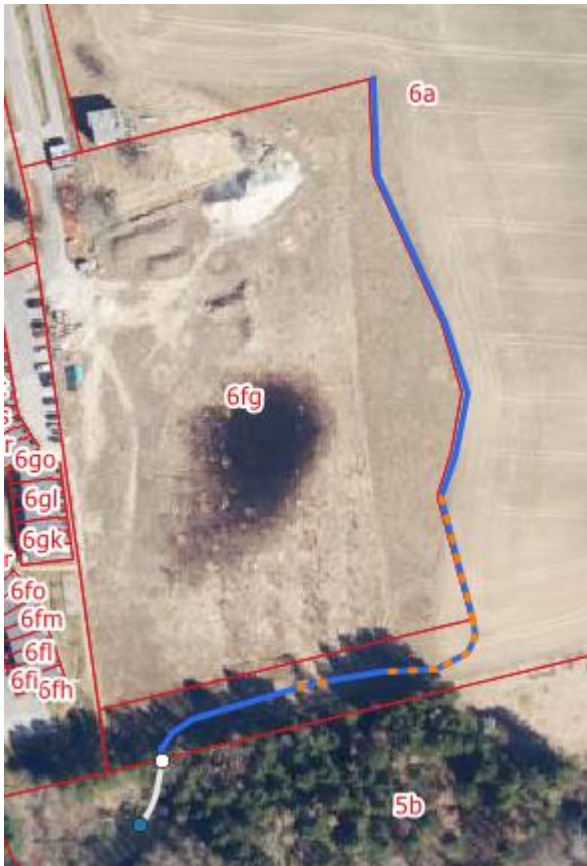
Figur 3 Principskitse for vandløbets placering og karakter: Vandløbsbund (blå linje), rørlagte strækninger (orange-stiplet), stensætning i skovbund (lysegrå), udløb til recipient (blåt punkt). Matrikelnumre med rødt. For detaljer se bilag 1
